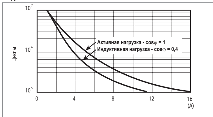
F 62 – График зависимости электрического ресурса при нагрузке AC от тока нагрузки
