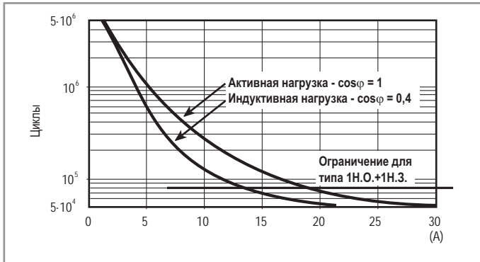
F 65 – График зависимости электрического ресурса при нагрузке АС от тока нагрузки
