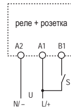
схема подключения с управляющим контактом Пуск
