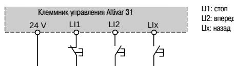
Схема соединений при 3-проводном управлении
