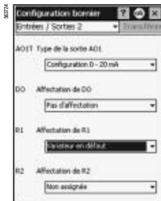
Конфигурирование реле неисправности с помощью PowerSuite для ПЧ
