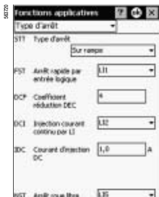
Конфигурирование типа остановки с помощью PowerSuite для ПК
