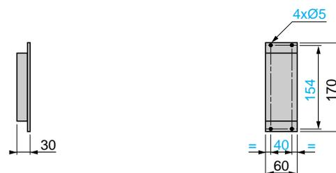
**Тормозной модуль VW3-A58701**
