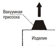
Использование присоски "на отрыв"
