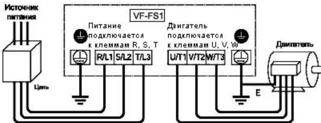
Подключение к источнику питания и двигателю
